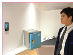
▲ 應用人工智能圖像辨識及microbit編程技術控制儲物櫃的開關
